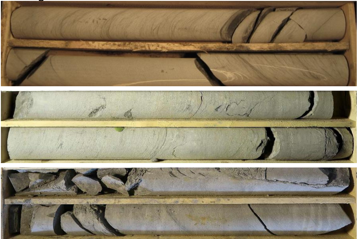
Beispielhafte Darstellung der Bohrkern
